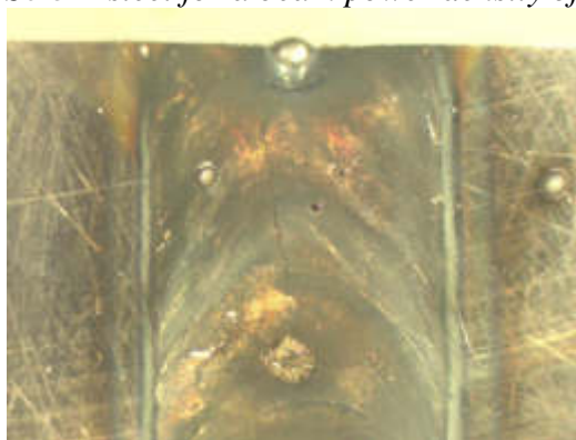
Rysunek 2. Lico przetopienia stali HS6-5-2 dla gęstości mocy wiązki 2,0 kW; WC Figure 2 Melting face of HS6-5-2 steel for a beam power density of 2.0 kW; WC
