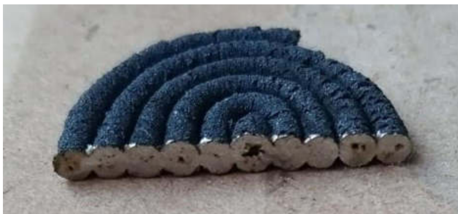
Rysunek 6. Próbkę z filamentu A po degradacji chemicznej i termicznej oraz po spiekaniu wysokotemperaturowym.
