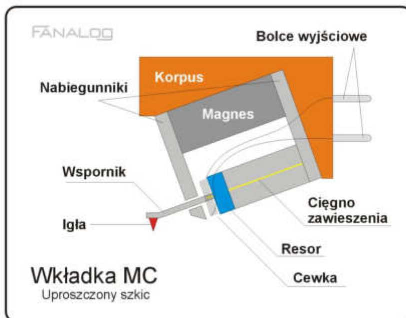
Rysunek 2. Schemat wkładki gramofonowej typu Moving Coil [3, 4] Figure 2. Diagram of a Moving Coil phono cartridge [3, 4]
