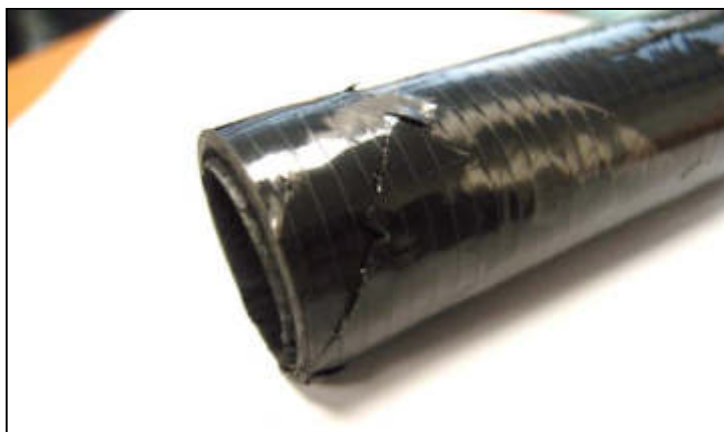
Obrázok 6. Poškodenie vzorky L=98mm.
