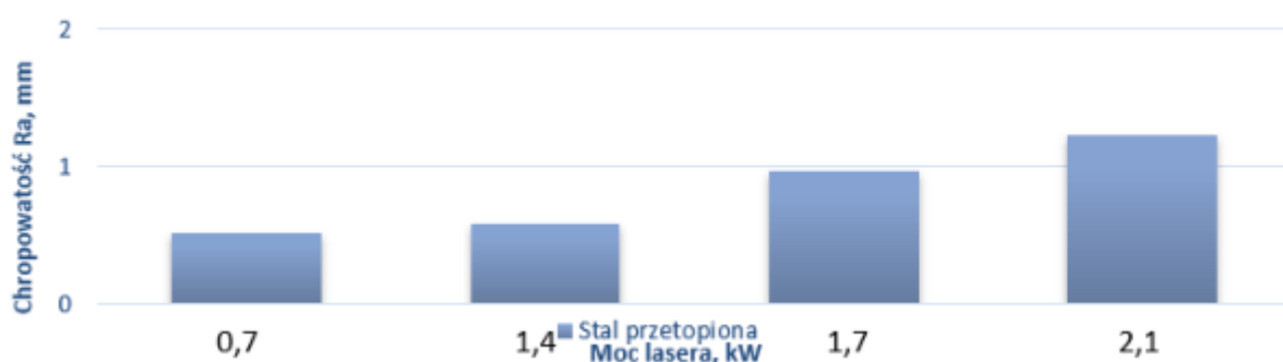
Rysunek 16. Wpływ mocy lasera na wartość parametru chropowatości warstwy wierzchniej stali HS6-5-3-8 po laserowym przetopieniu laserem o mocy 0,7 kW, 1,4 kW, 1,7 kW, 2,1 kW, przy stałej prędkości przetapiania 0,5 m/min
