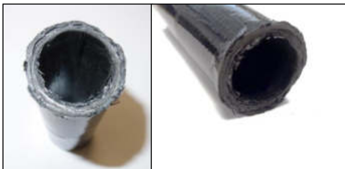
Obrázok 9. Poškodenie uhlíkových profilov pri skúške tlakom.
