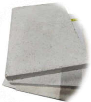
Rys. 2 Płyta izolacyjna z grzybni (opracowanie własne)
