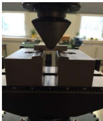
Obrázok 2. Detail na skúšobnú vzorku pri trojbodovom ohybe Figure 2. Detail of a test specimen at three-point bending
