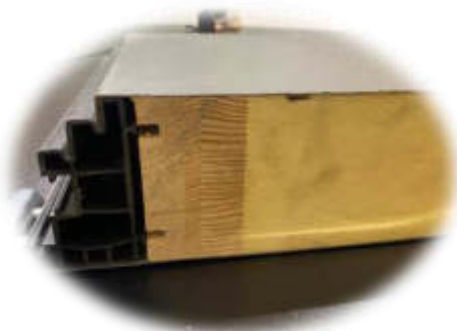
Rys. 1 Przekrój skrzydła z wypełnieniem poliuretanowym (opracowanie własne)
