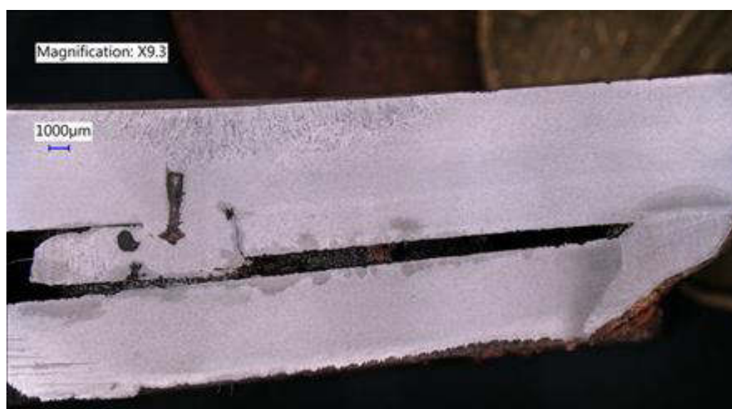
Obrázok 6. Makroštruktúra materiálu v časti 1s časťou zvaru, lept. Nital Figure 6. Makrostructure of material 1 with weld spot, etch. Nital
