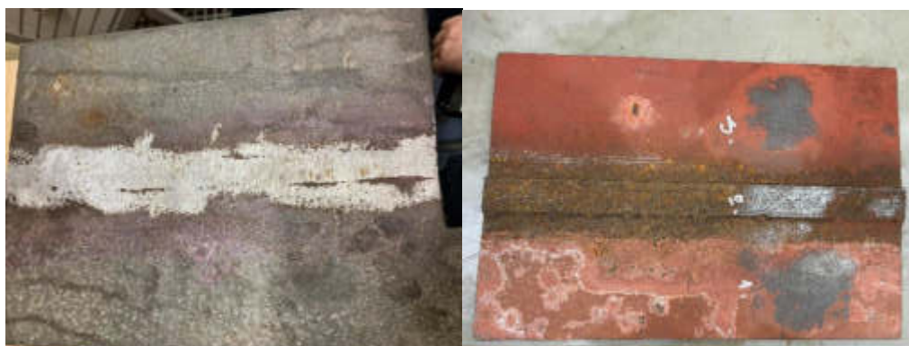
Obrázok 3. Výrez dna nádrže PHM zásobníka zo spoločnosti Slovnaft, a.s. (vrchná strana vzorky - vľavo, spodná strana vzorky - vpravo)
