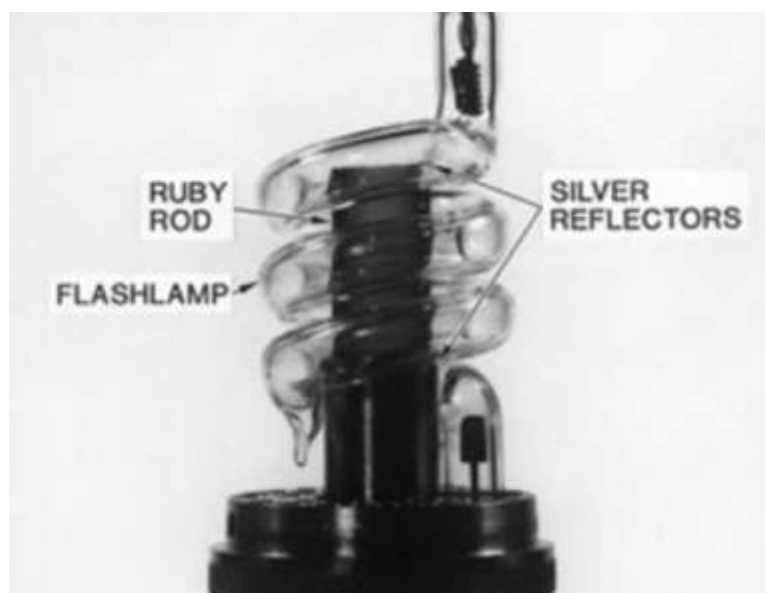
Rysunek 2. Pierwszy laser (Ruby rod-rubinowy ośrodek czynny, flashlamp-lampa błyskowa, silver reflectors-srebrne lustra) [3]
