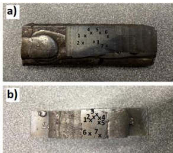
Rys. 2. Rozmieszczenie punktów pomiarowych badania twardości metodą Rockwella próbek: a) AM, b) BM
