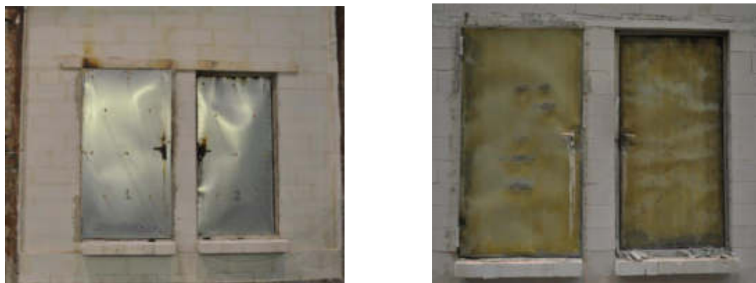
Rysunek 2. Po lewej drzwi stalowe po 37 minutach od strony nienagrzewanej, po prawej drzwi stalowe po ostudzeniu [ materiały własne].
