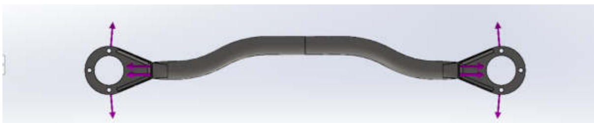
Rys. 5. Miejsce przyłożenia sił rozciągających.
