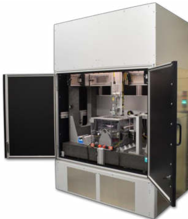
Rysunek 6 Centrum obróbkowe sterowane numerycznie firmy SYLAS przeznaczone do polerowania laserowego [19]
