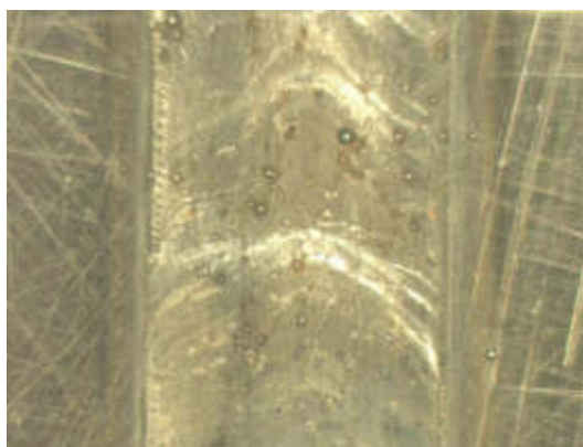
Rysunek 1. Lico przetopienia stali HS6-5-2 dla gęstości mocy wiązki 1,7 kW; WC Figure 1 Melting face of HS6-5-2 steel for a beam power density of 1.7 kW; WC
