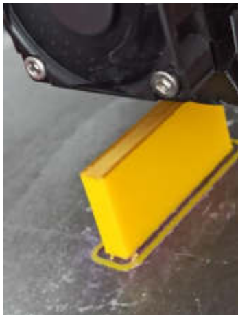
Rysunek 7. a) Drukowanie próbki, b) gotowa próbka Figure 7. a) Printing the sample, b) finished sample
