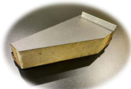
Rys. 2. Przekrój skrzydła z wypełnieniem XPS (opracowanie własne)
